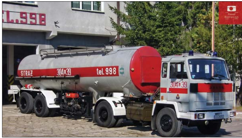
Jelcz C417/Metalchem - JRG Bełżyce, Ciągnik siodłowy Jelcz 417 z cysterną o pojemności 18000 litrów użytkowany przez JRG PSP w Bełżycach.
