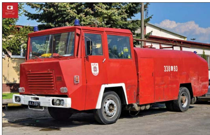
338[L]93 - GCBM 10/40 Jelcz P420/SHL - OSP Podole Ciężki pojazd gaśniczy marki Jelcz-SHL A3-515 Hydromil II o pojemności zbiornika 10000 litrów wody należący do Ochotniczej Straży Pożarnej Podole. a w 2017 roku został zastąpiony przez Mercedes Benz 1222 A, zaliczany do wozów średnich, który może pomieścić do 2,5 tys. litrów wody.
