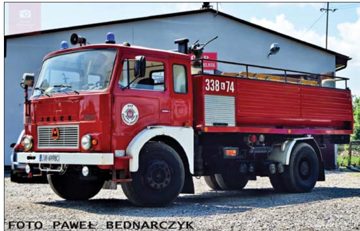
338[L]74 - GCBA 6/32 Jelcz 325/JZS - OSP Kolonia Chmielnik Ciężki samochód gaśniczy wodno-pianowy typu Jelcz 004M o pojemności 6000 litrów należący do OSP Kolonia Chmielnik. Jelcz został pozyskany z JRG 2 w Lublinie.
